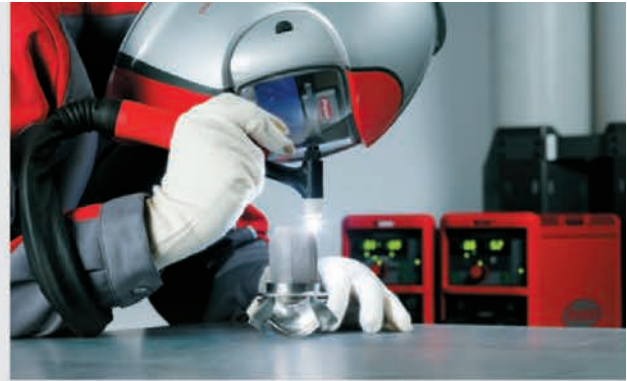
/ Manuelles Mikroplasma-Schweißen für Blechdicken ab 0,1 mm.
