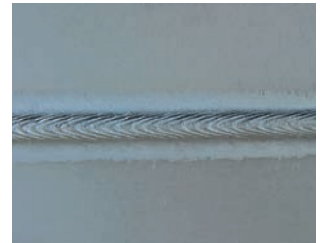
Kehlnah an 1,0mm AlMg3-Blech mit 2,0 m/min Schweißgeschwindigkeit.
