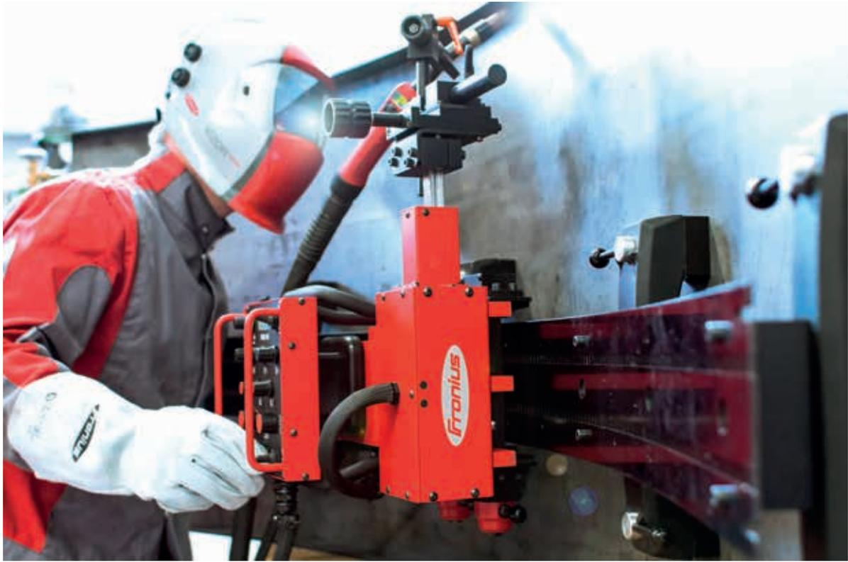
Flextrack 45 - mechanisiertes Schweißen mit einem Fahrwerk über Schienenführung für Längs- und Rundnahtaufgaben.
