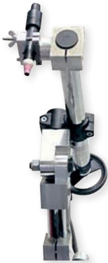
Komplett mit Universalbrennerklemme und Brennerschwenkeinrichtung, Handhebelventil, Druckregler und Schläuchen.
