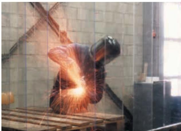
Schleiflamellen und Schleifvorhänge bieten in gleicher Weise Schutz. Die Entscheidung, ob Vorhänge oder Lamellen verwendet werden, hängt von der mechanischen Belastung ab. So ist empfehlenswert, bei starker oder frequenzierter mechanischer Belastung Lamellen einzusetzen.
