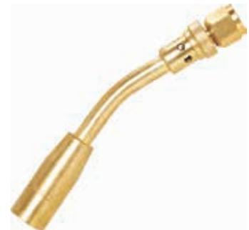
**Verbindungsrohr** als Verbindung vom Handgriff zum Brennerkopf. Anschluss am Handgriff M14 x 1ÜM, Brennerkopf: AG M 20 x 1.
