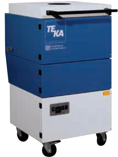
Da die Filterpatrone abreinigbar ist, entstehen bei diesem Gerät nur minimale Folgekosten. Die Filterpatrone bleibt beim Abreinigen in der Anlage, so dass keine Stäube in den Arbeitsraum gelangen können. Die abgereinigten Partikel werden in einer Staubsammellade gesammelt und können anschließend entsorgt werden.
