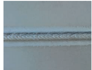
Kehlnah an 1,0mm AlMg3-Blech mit 2,0 m/min Schweißgeschwindigkeit.
